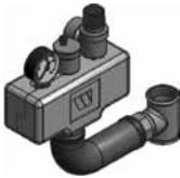
Предохранительный клапан с давлением срабатывания 3 бар, манометр, автоматический клапан для выпуска воздуха с запорным устройством, теплоизоляция.
