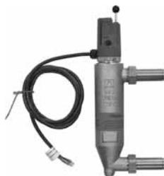
Каждый отопительный котел должен оснащаться прошедшим испытания предохранительным устройством для отключения при недостатке воды. В случае теплогенераторов мощностью до 300 кВт можно не устанавливать такое устройство, так как недопустимый нагрев при недостатке воды невозможен. Это обеспечивается предохранительным ограничителем температуры (STB) в системе регулирования, что было подтверждено при испытании типового образца.
